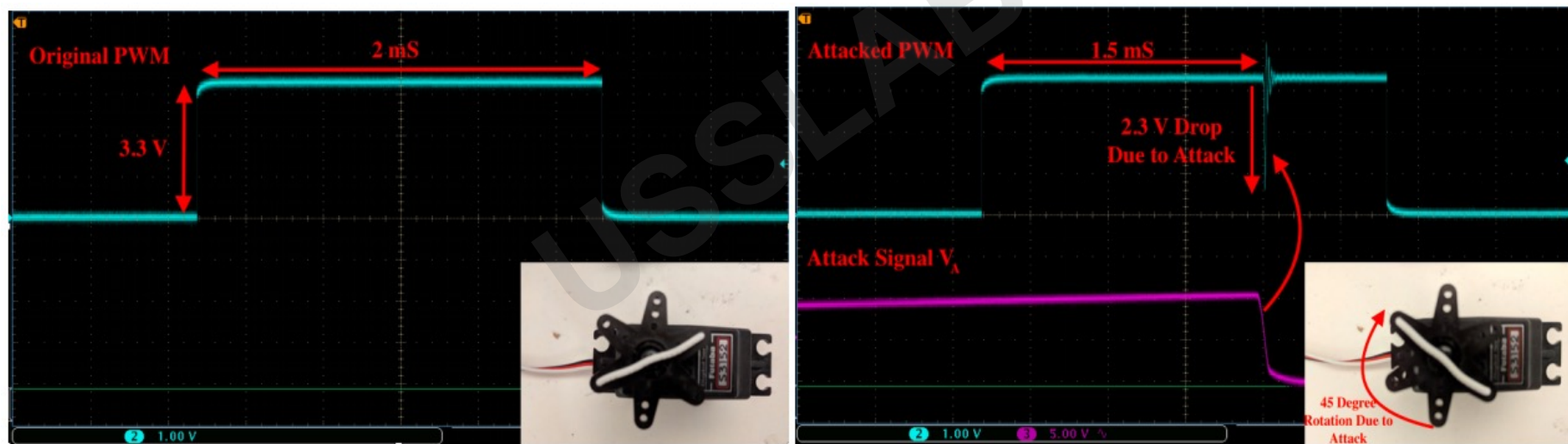
(b) 攻击信号 V_A (紫色)；被攻击PWM信号 (蓝色) 和对应的伺服电机位置
